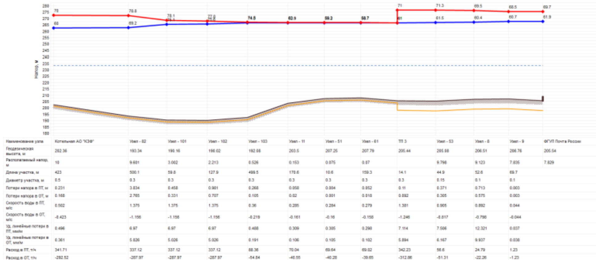
Рисунок 58. Пьезометрический график тепловых сетей от котельной АО «КЗФ», п. Двуреченск (через ЦТП №3)
