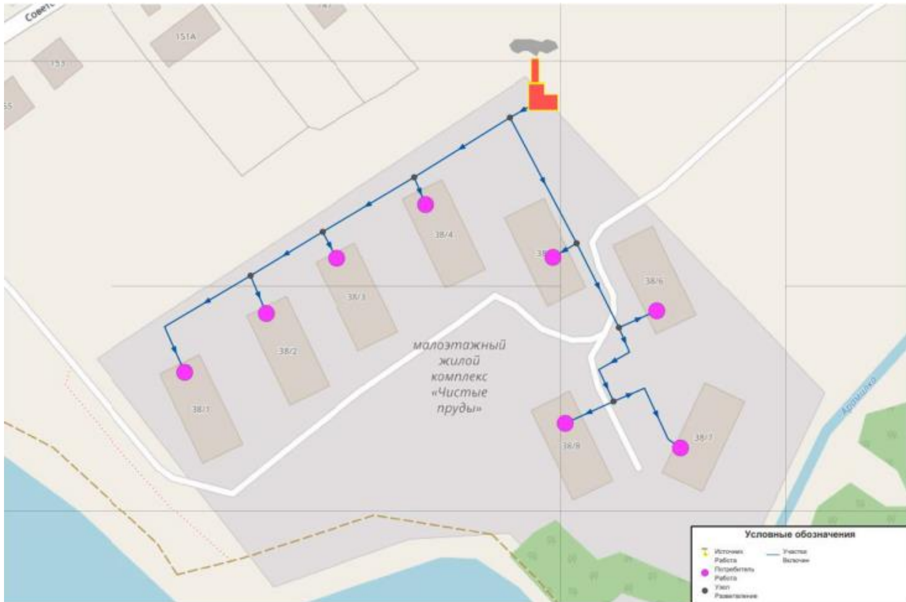
Рисунок 34. Схема существующего расположения сетей теплоснабжения в зоне действия котельной, с. Патруши, ул. Пионерская, 38
