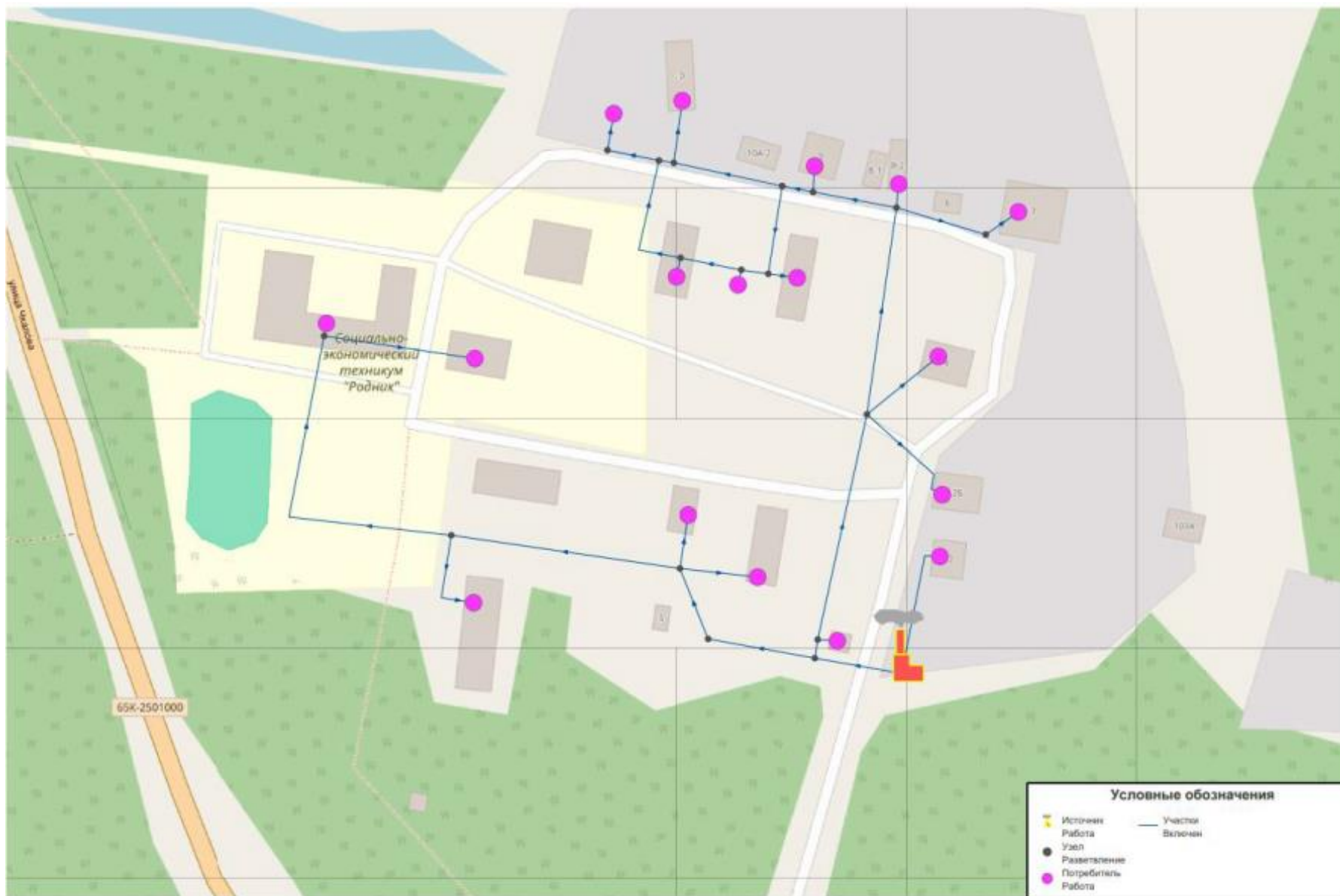
Рисунок 5. Схема существующего расположения сетей теплоснабжения в зоне действия котельной, г. Сысерть, мкр-н Воробьевка
