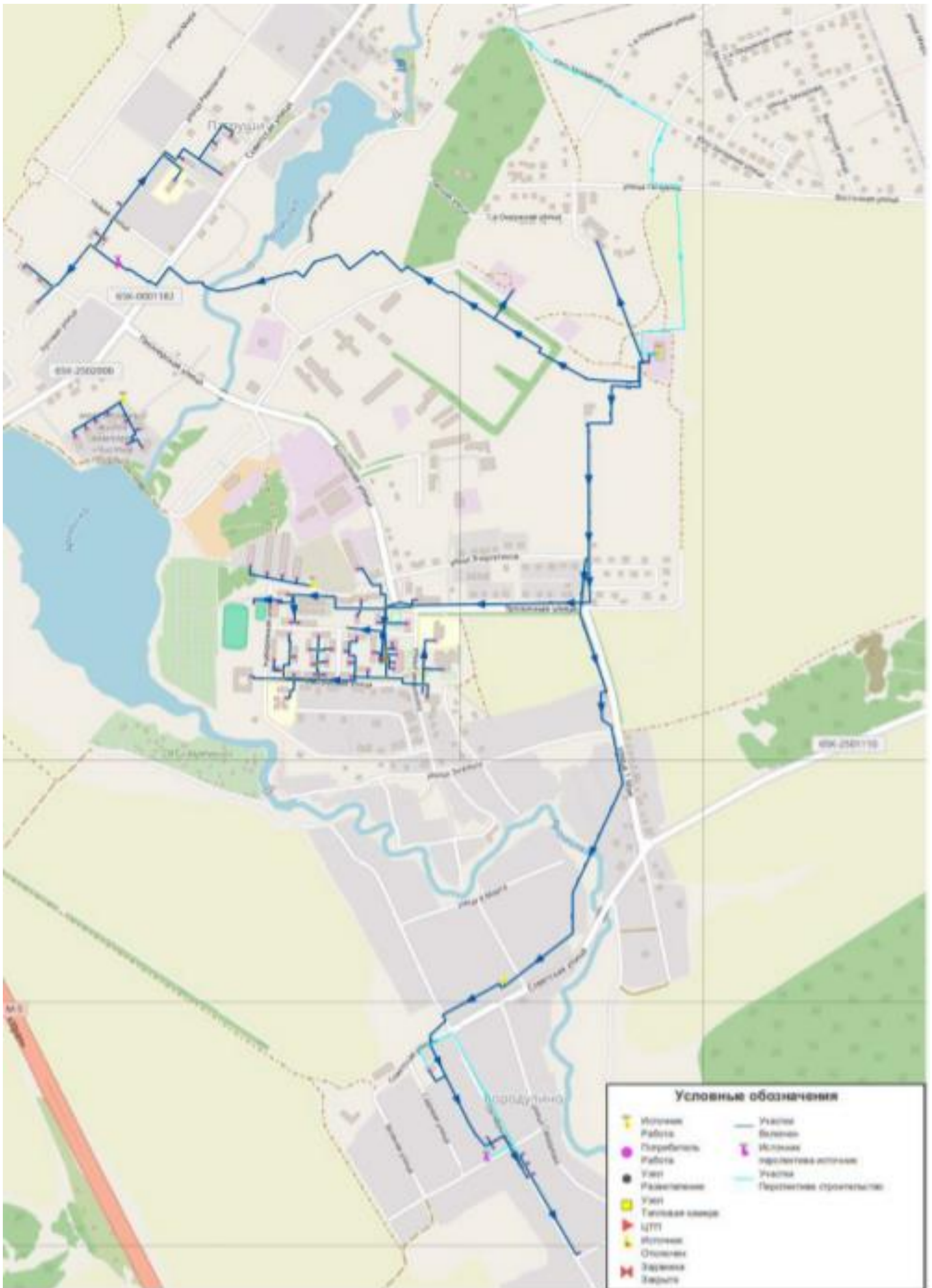
Рисунок 36. Схема перспективного расположения сетей теплоснабжения в зоне действия котельной, с. Патруши, ул. Тепличная, 21
